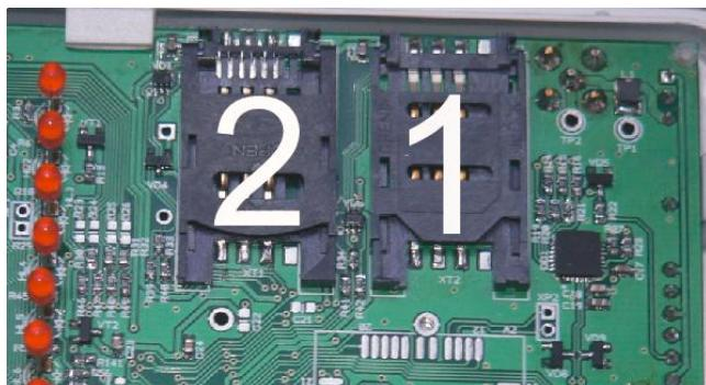
Прибор «Часовой 8x8-RF-BOX» имеет два слота для установки SIM-карты. Они показаны на рисунке: цифрой «1» обозначен основной слот, цифрой «2» резервный. Для работы прибора достаточно наличия SIM-карты в основном слоте.
