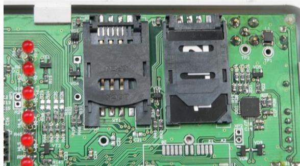
Устанавливаем SIM-карту в крышку слота и закрываем его в обратном порядке открытию.
