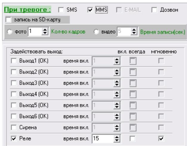
Захват изображения с дополнительной видеокамеры возможен только при включении встроенного РЕЛЕ прибора. Для этого необходимо (при возникновении тревожной ситуации по входу) включить РЕЛЕ на 15 секунд. При тревоге по выбранному входу произойдёт переключение видеосигнала от основной камеры на дополнительную. Для захвата изображения с основной камеры, включать РЕЛЕ не нужно.
