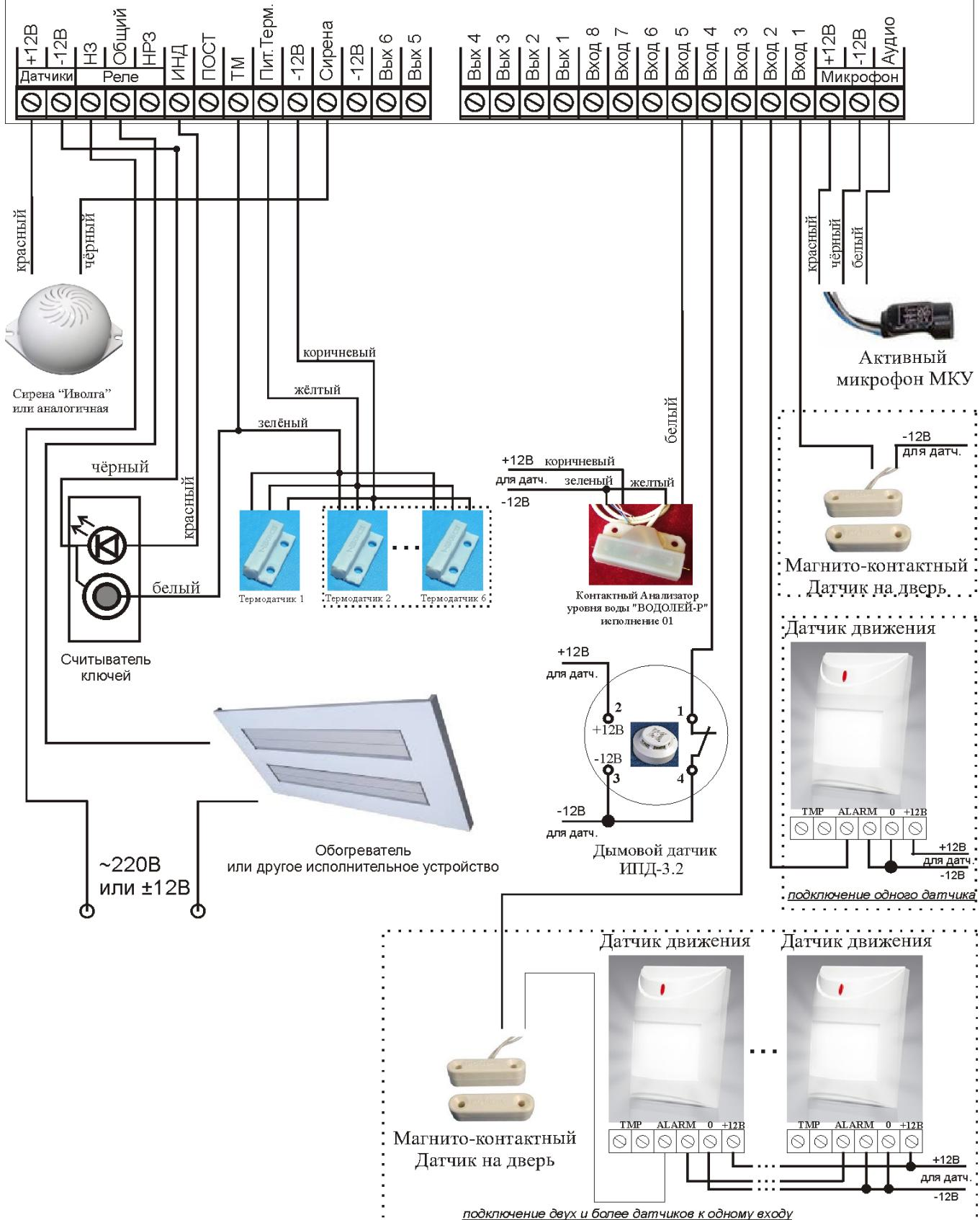
Если Вам подходит типовая схема подключения, то в программе конфигураторе задайте необходимые параметры.
