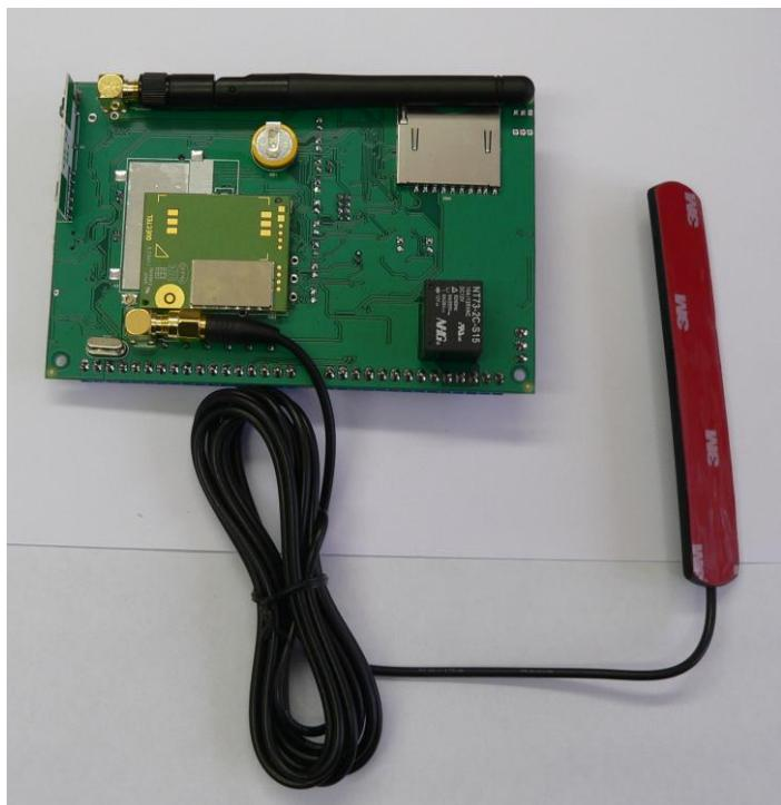
Антenna 433 МГц для радиоканальных датчиков уже установлена в прибор.
