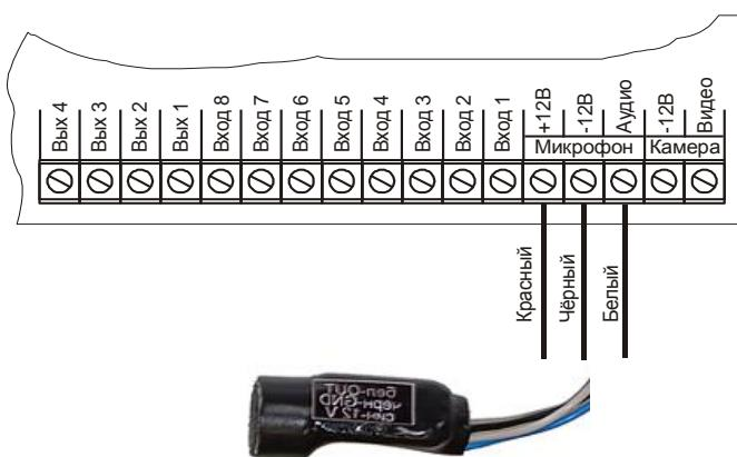
Подключение микрофона производится к специально предназначенным клеммам Прибора («+12В» «-12В» «Аудио»). Микрофон необходимо подключать именно к этим клеммам.
