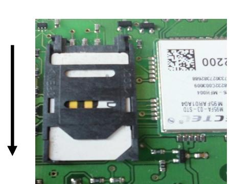
Закрыть лоток. Задвинуть крышку по направлению стрелки.
